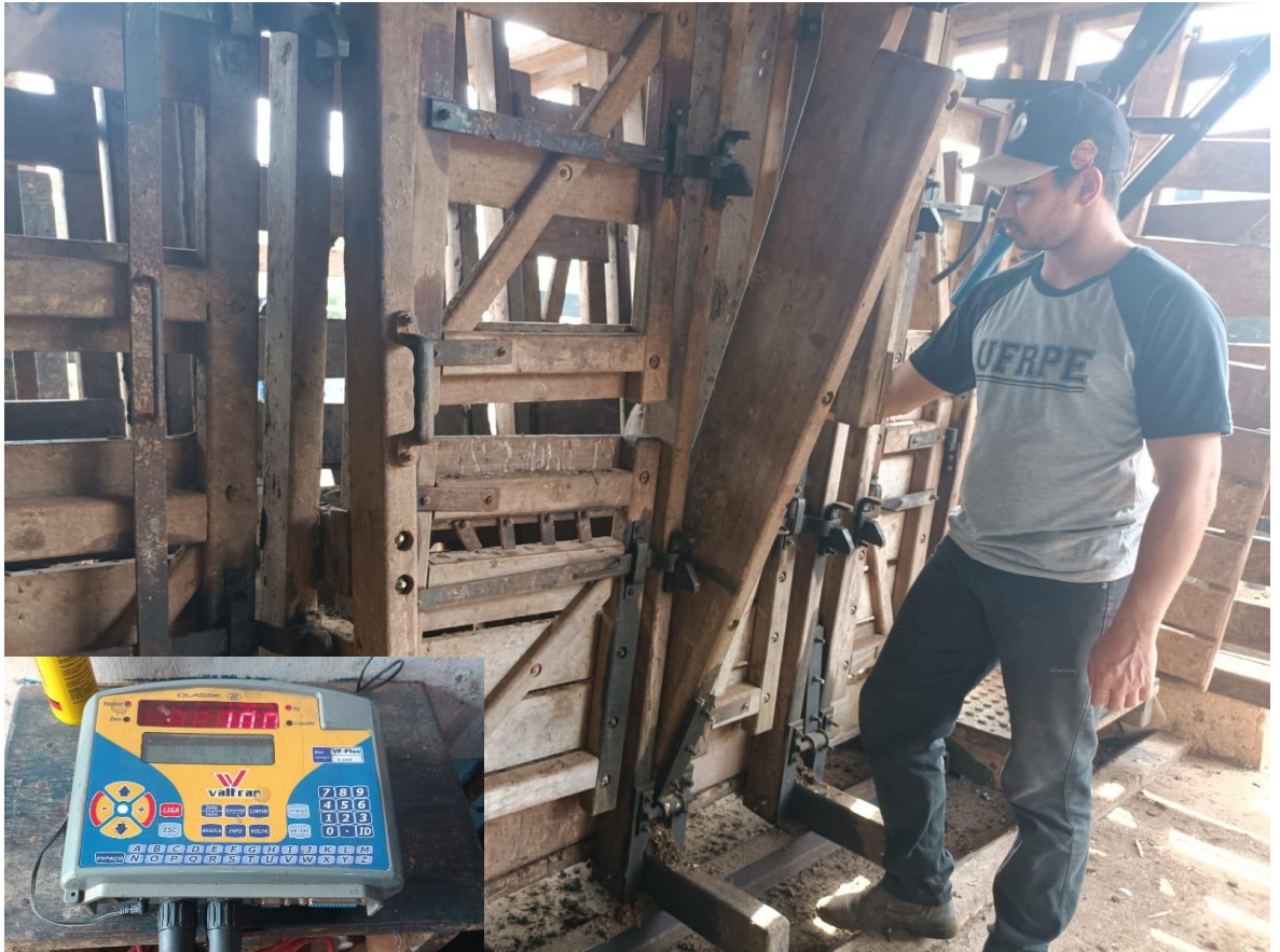
Figura 2: Tronco de contenção e balança digital. Fonte: Acervo pessoal
