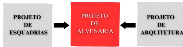
Figura 14 - Esquema de compatibilização de projeto de alvenaria com o projeto de esquadrias e arquitetura.
