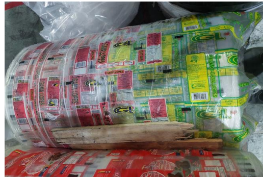
Figura 6 – Falha no condicionamento de bobinas no setor do refile.
