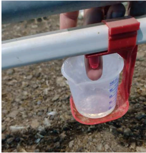
Figura 29 – Verificação de vazão de bebedouro tipo nipple . Fonte: Arquivo Pessoal, 2023 (Autorizado pela Empresa).
