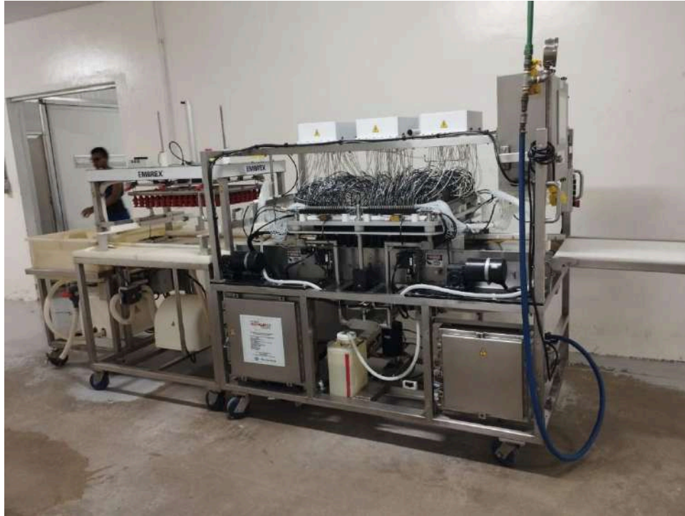
Figura 18 – Máquina de vacinação in ovo . Fonte: Arquivo pessoal, 2023 (Autorizado pela empresa).
