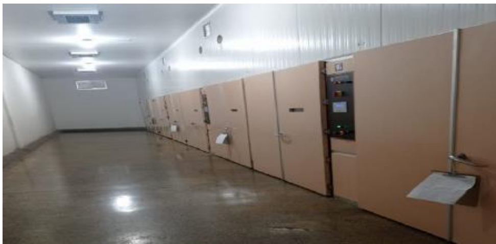
Figura 7: Incubadoras de estágio múltiplo
