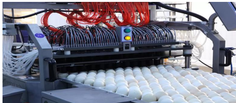
Figura 10: Máquina vacinadora de ovos férteis. Fonte: Google imagens
