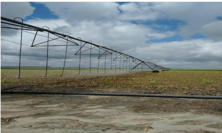
**Figura 9: Pivô linear em funcionamento.**
