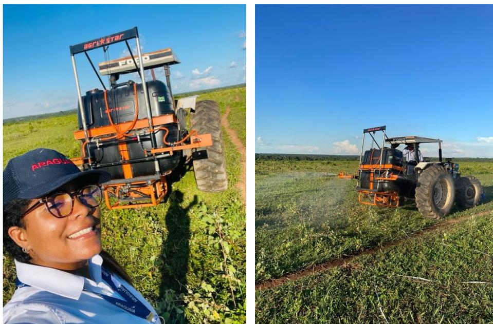
**Figura 11 e 12.** Realização de regulagem de pulverizador utilizando água. (Fonte: arquivo pessoal, 2024).
