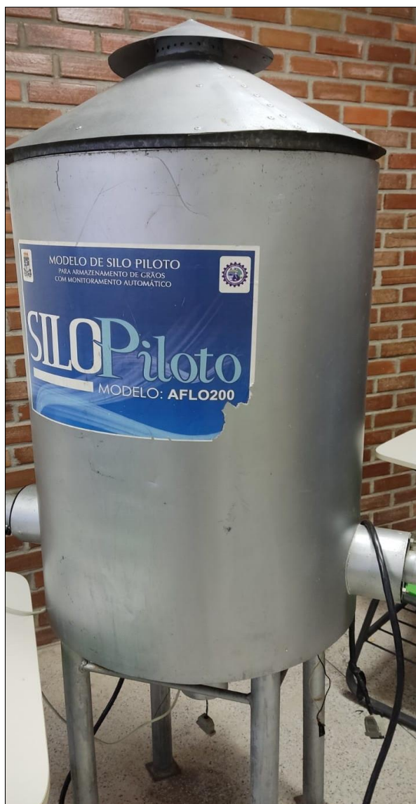
Figura 5 - Silo Piloto do laboratório de armazenagem
