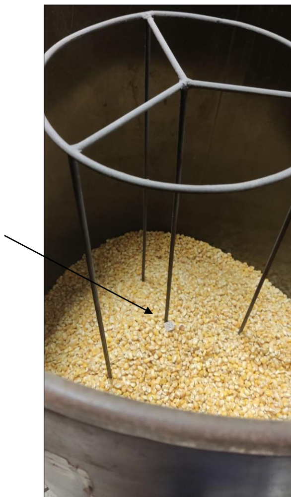
Figura 6 – Estrutura interna do silo com o sensor conectado ao centro
