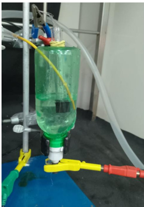
Figura 18. Célula eletroquímica de cavidade utilizada para síntese dos PQs.
