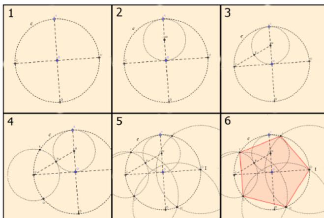
Figura 2.10: Construção de um Pentágono
