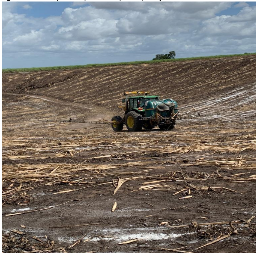
Figura 12: Herbplus, implemento para aplicação mecanizada de herbicida
