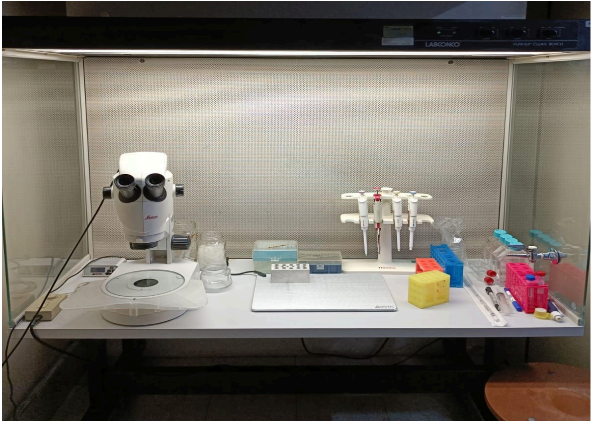
Figura 19. Capela de fluxo laminar equipada com esteromicroscópio, placa aquedora e pipetas. Fonte: Autor (2024).
