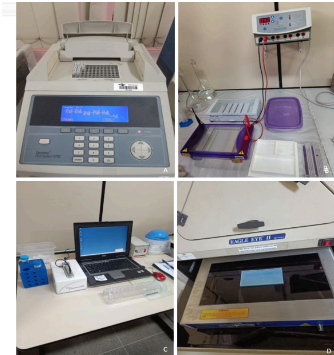
Figura 4. Equipamentos para uso em biologia molecular; A. Termociclador; B. Cuba de eletroforese; C. Espectrofotômetro; D. Fotodocumentador (Eagle Eye II). Fonte: Autor (2023).
