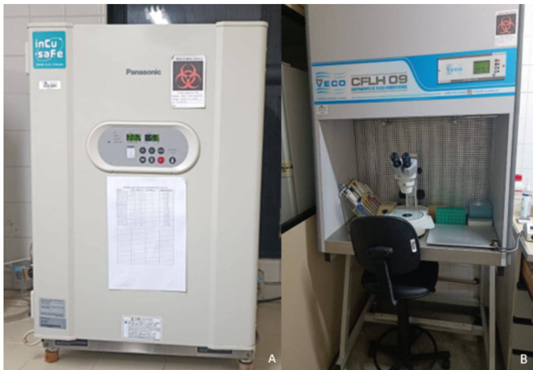
Figura 3. Equipamentos do Laboratório de Reprodução Animal; A. Incubadora de atmosfera controlada para a maturação dos oócitos, incubação dos gametas e cultivo de embriões; B. Capela de fluxo contínuo contendo pipetas, estereomicroscópio e placa aquecedora para manipulação de gametas e embriões. Fonte: Autor (2023).
