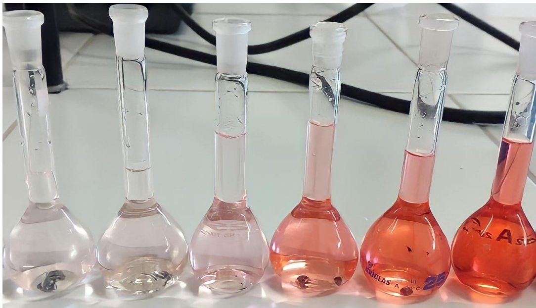
Figura 14. Soluções utilizadas para construção da curva analítica com concentrações de 2 \times 10^{-4} ; 5 \times 10^{-4} ; 1 \times 10^{-3} ; 5 \times 10^{-3} ; 1 \times 10^{-2} e 2 \times 10^{-2} mg mL -1 , respectivamente, do padrão do corante Vermelho allura Ac (método proposto).
