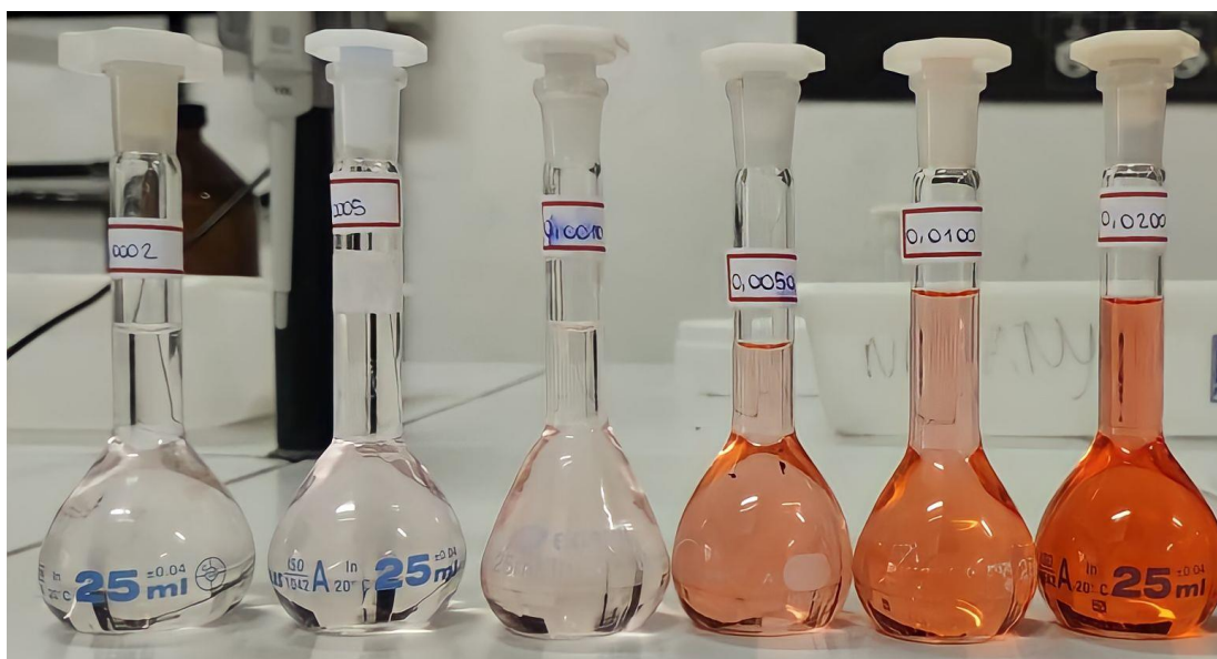
Figura 12. Soluções utilizadas para construção da curva analítica com concentrações de 2 \times 10^{-4} ; 5 \times 10^{-4} ; 1 \times 10^{-3} ; 5 \times 10^{-3} ; 1 \times 10^{-2} e 2 \times 10^{-2} mg mL -1 do padrão do corante Vermelho allura Ac (método de referência).
