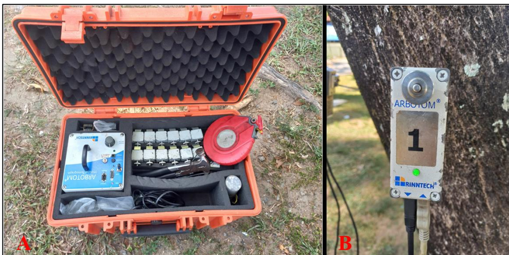
Figura 5. A – Conjunto do equipamento do Tomógrafo ARBOTOM®. B- Sensor utilizado para aferimento do tomógrafo. Fonte: O autor, 2024.
