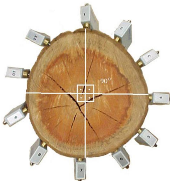
Figura 1. Modo de funcionamento e instalação dos sensores do tomógrafo ARBOTOM. Fonte: ROLLO et al., (2013).
