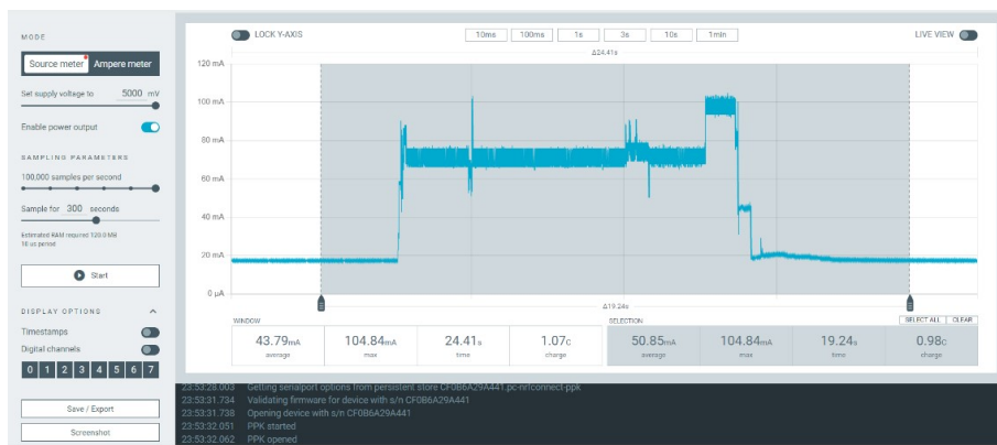
Figura 16. Perfil de consumo do dispositivo em modo Deep Sleep. Fonte: Autoria própria.
