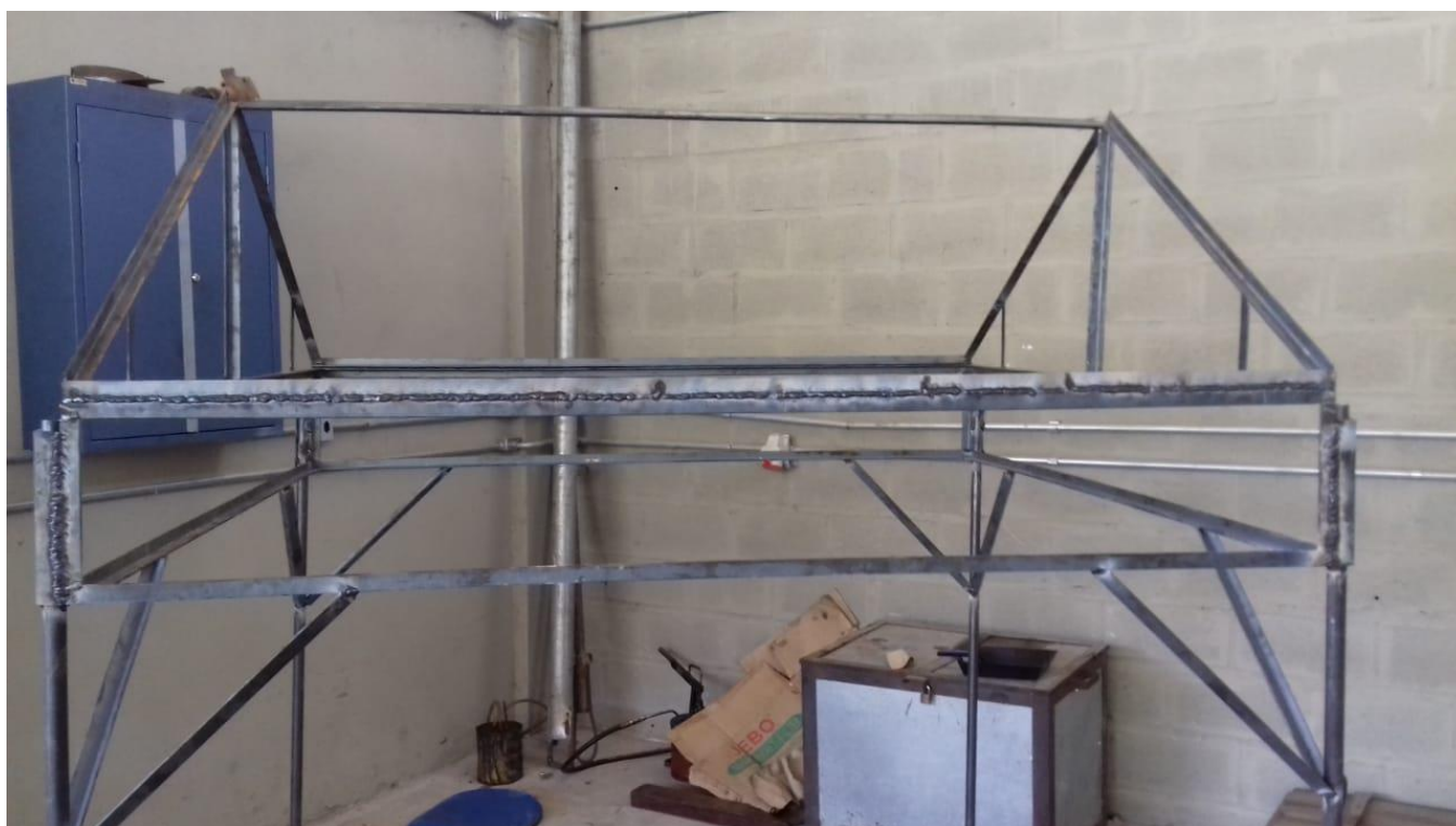
Figura 20. Estrutura do dessalinizador solar plano pronta.
