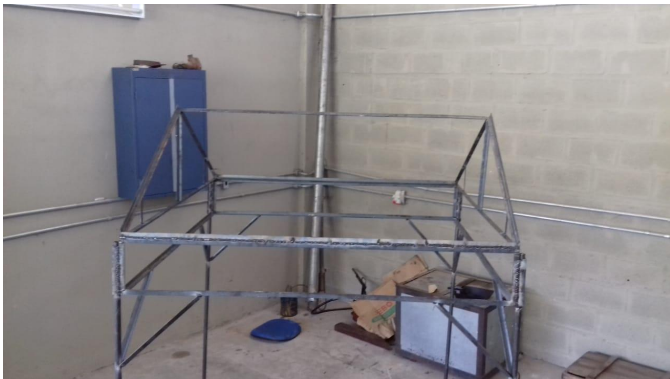
Figura 19. Estrutura do dessalinizador solar plano pronta.
