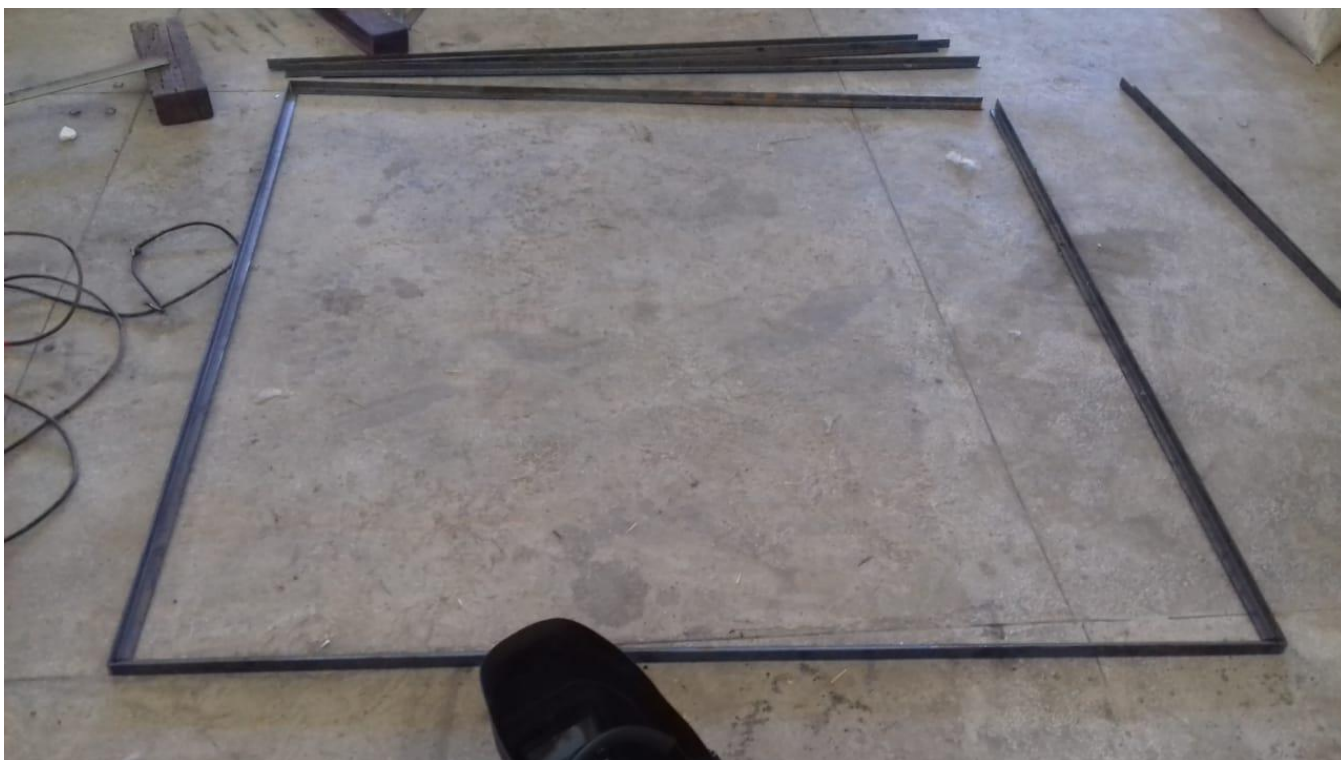
Figura 13. Início da montagem da base do dessalinizador solar plano.
