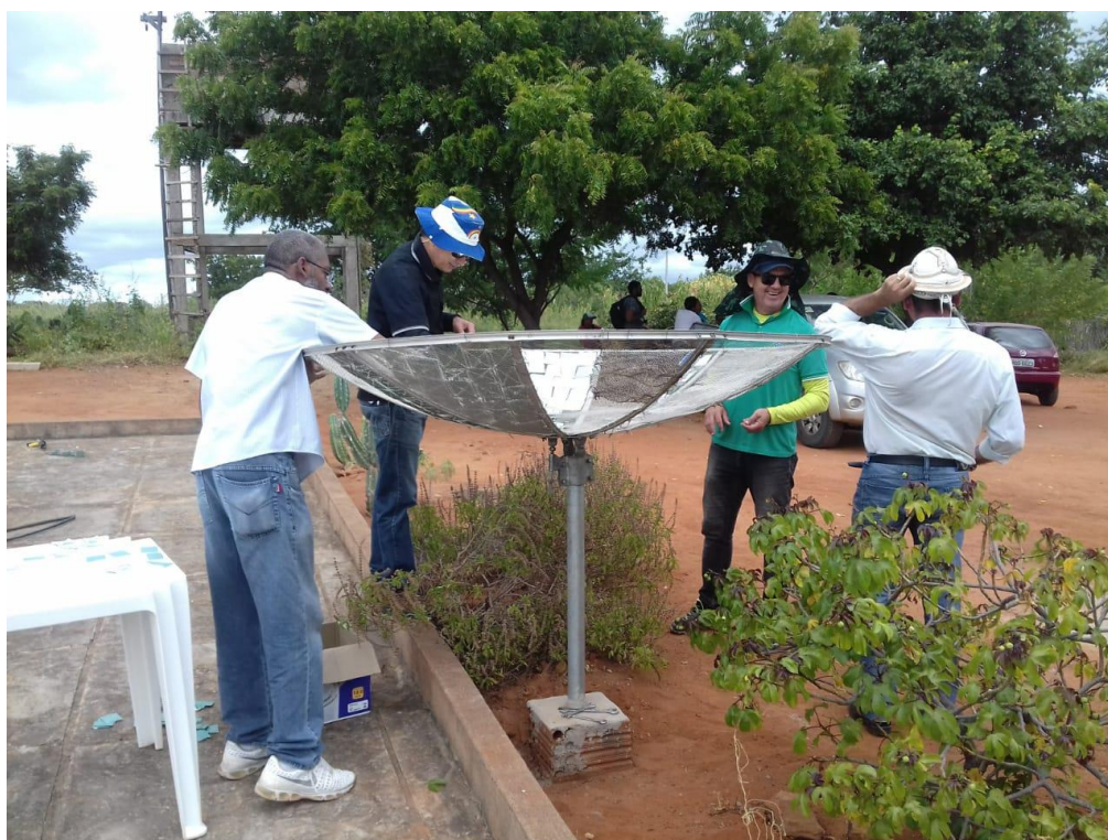
Figura 10. Equipe fixando os espelhos na antena parabólica.
