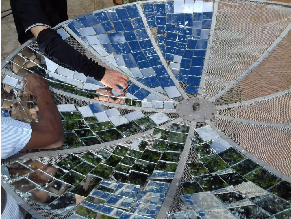
Figura 11. Equipe fixando os espelhos na antena parabólica.
