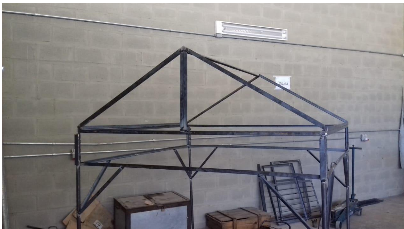
Figura 18. Estrutura do dessalinizador solar plano pronto.
