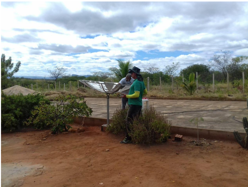
Figura 9. Fixação dos espelhos na antena parabólica.
