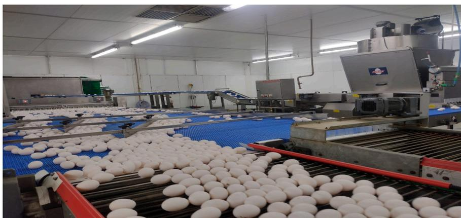
Figura 56 – Esteira na área suja do Centro de Processamento de Ovos e, à direita, Lavadora de Ovos.
