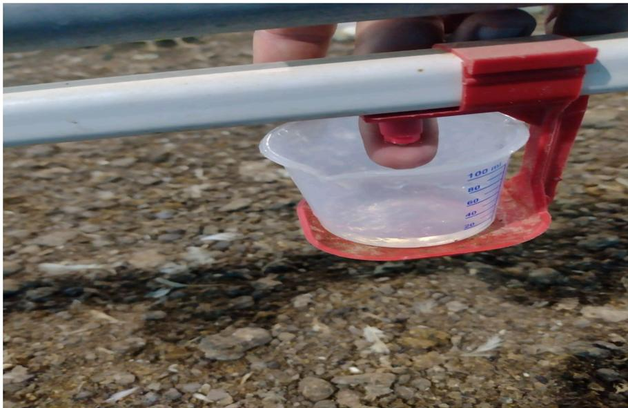
Figura 33 – Teste de vazão de bebedouro *Nipple*. Fonte: Arquivo Pessoal, 2023 (Autorizado pela Empresa).
