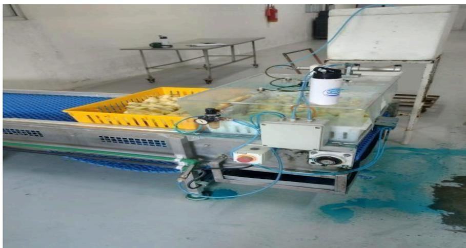
Figura 18 – Vacinadora *in spray*, incubatório Sertãozinho–PB. Fonte: Arquivo Pessoal, 2023 (Autorizado pela Empresa).
