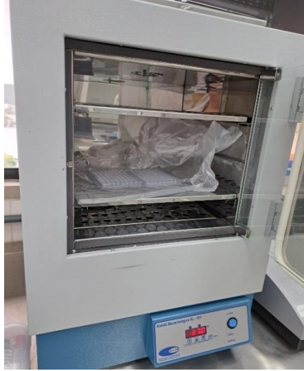
Figura 13. Estufa bacteriológica a 37°C para incubação da placa para o Teste de Soroaglutinação microscópica.
