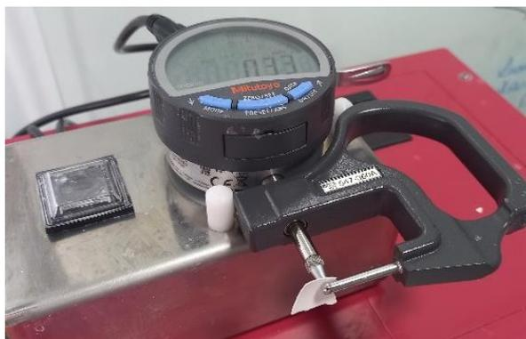
**Figura 29.** Medição de Espessura da casca.
