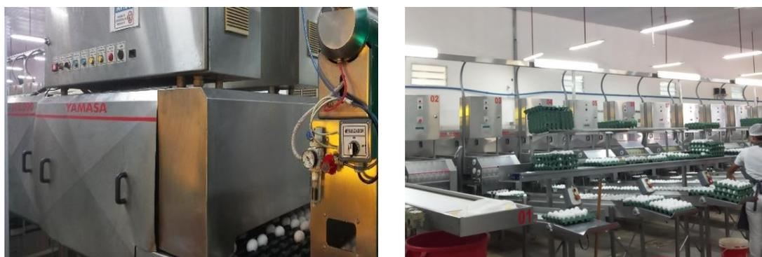
**Figura 21.** Balança e bocas da classificadora.
