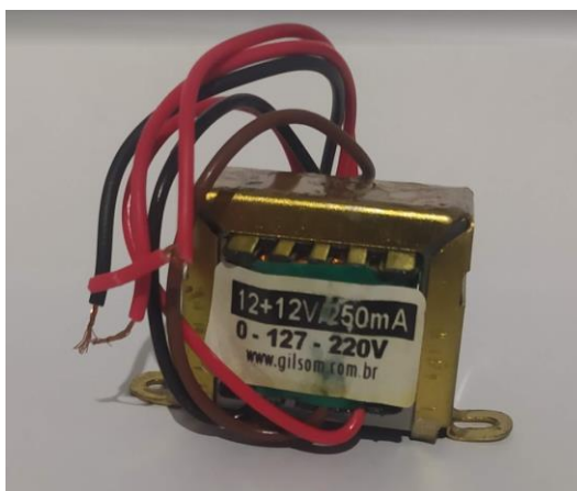
Figura 7 – Transformador de potencial adotado.
