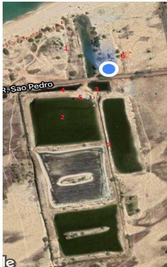
**Legenda: 1 - canal de abastecimento, 2 - viveiros, 3 - lagoa de captação e casa de bomba, 4 - canal de drenagem, 5 - berçários, 6 - casa de apoio, 7 - canal de distribuição de água**
