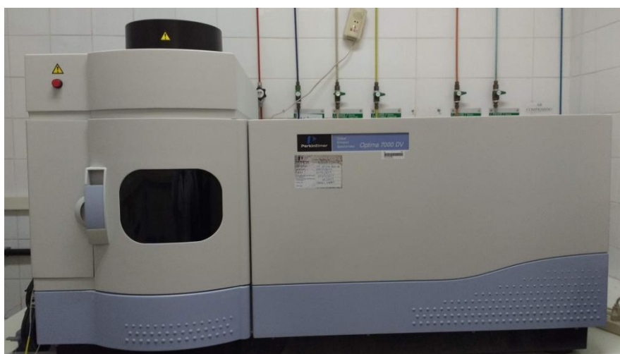
Figura 12: Equipamento usado para as análises de metais pesado - ICP OES modelo Optima DV 7000 (Perkin Elmer, EUA)
