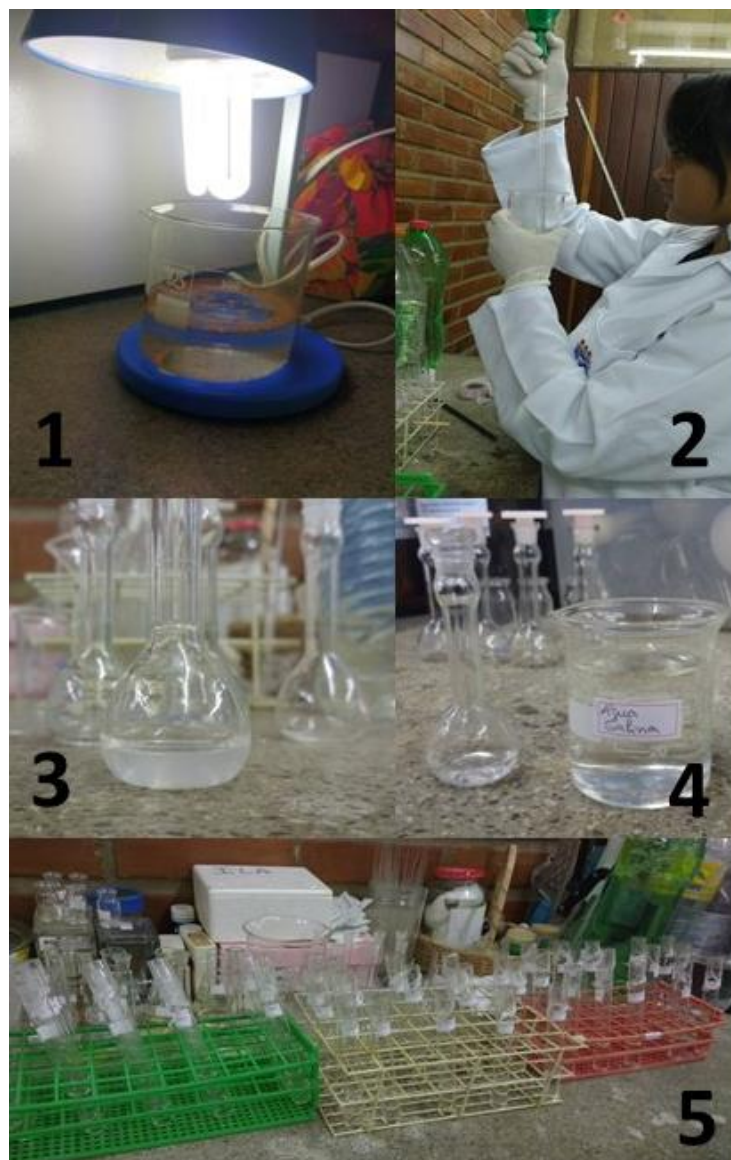
Figura 06: Análise e organização das amostras do muco cloacal das tartarugas marinhas registradas na temporada 2017-2018, Ipojuca/PE. (1) Ovos de Artemia salina colocados para eclodir na água do mar durante um período de 24 horas. (2) Preparação das soluções estoques. (3) 1 mL do muco no balão volumétrico de 10 mL. (4) Água salina usada para produção da solução, onde 1 mL era do muco e 9 mL de água salina. (5) Após adicionar os 10 náuplios em cada amostra, esperava-se 24 horas para contagem da quantidade de mortos.
