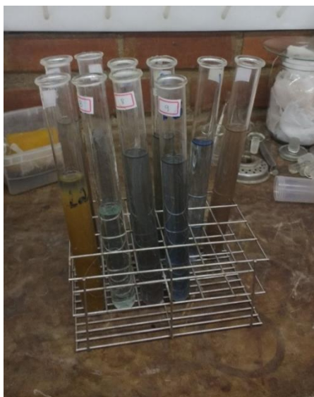
Figura 08: Soluções após o período de digestão e 24 horas na estufa a 60°C
