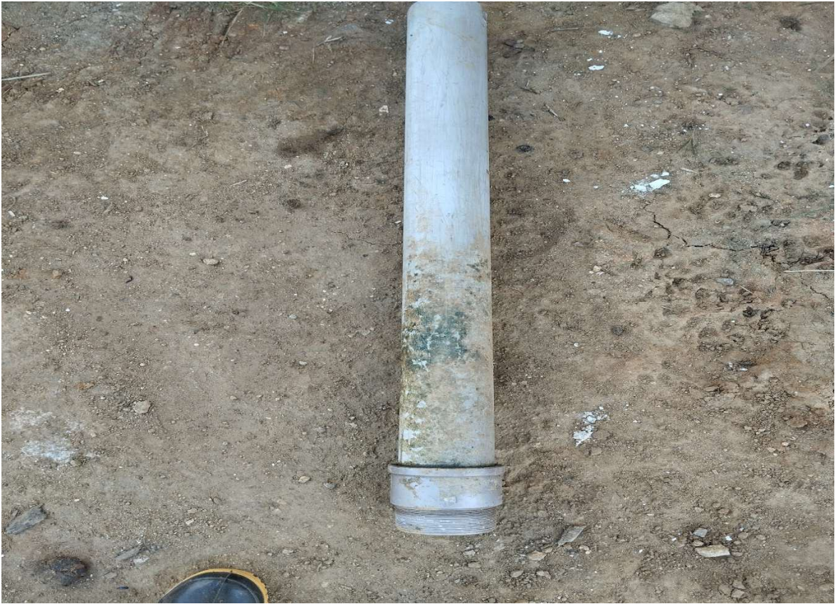
Figura 14 Tubo 75mm roscável usado como registro
