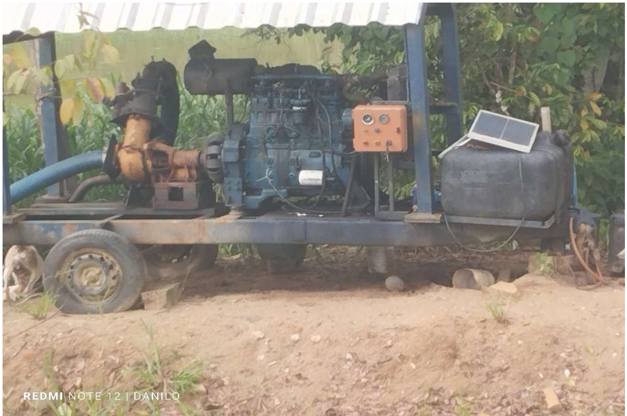
Figura 4. Bomba de dragagem acoplada ao motor MWM.
