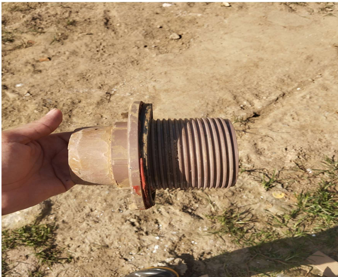
Figura 13 Flange 75 mm utilizado nos berçários com função de registro para transferência das pós larvas
