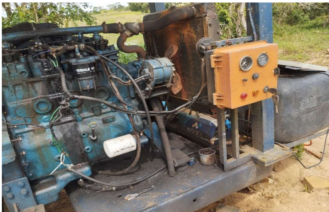
Figura 5. Motor MWM utilizado no bombeamento de água para os viveiros
