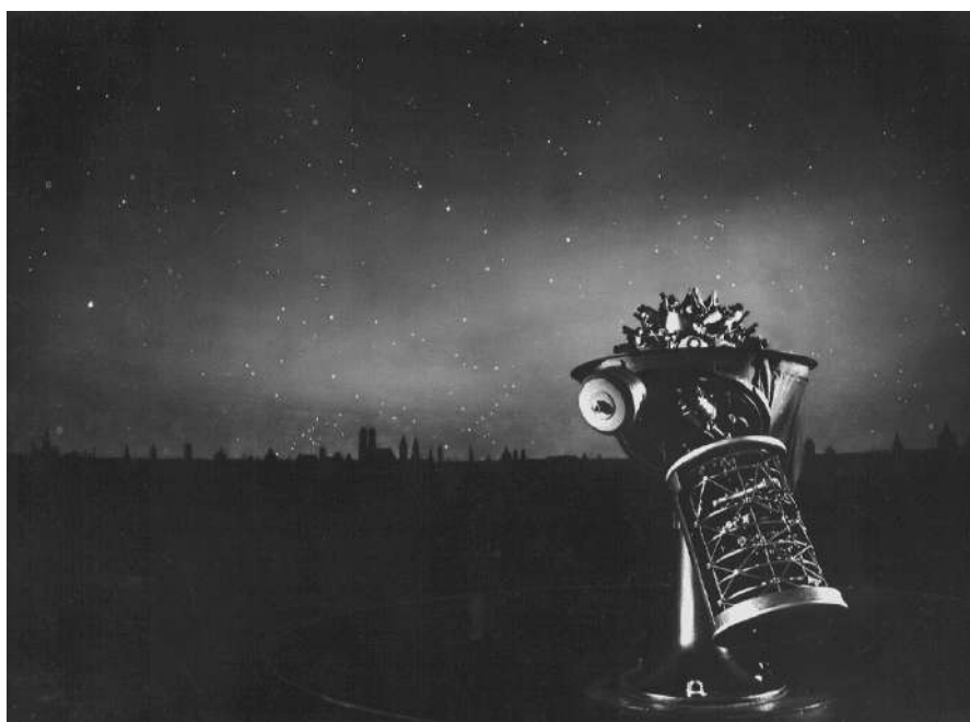
Figura 1 - Projetor Zeiss Mark I, do primeiro planetário moderno
