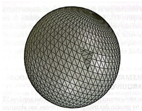
Figura 22 – Esfera com abertura devido à falta de triângulos
