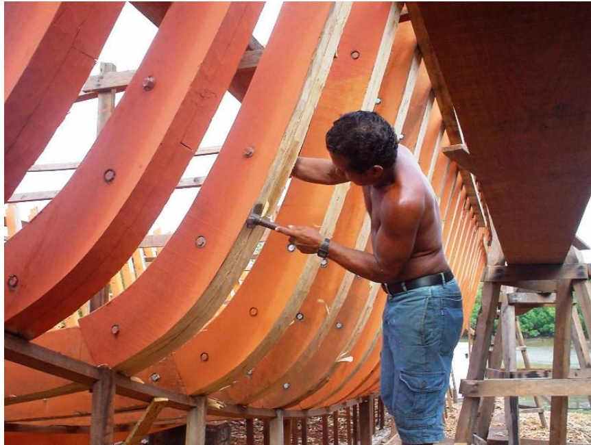
Figura 5. conjunto de costelas formando as cavernas da embarcação.
