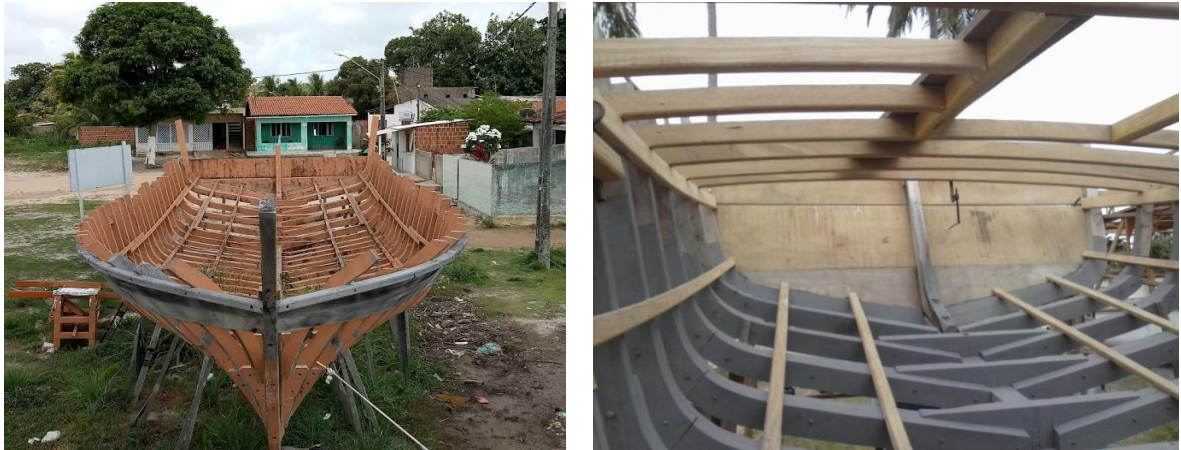
Figura 9. (A) esqueleto da embarcação, (B) vista interna, latas superiores e espelho de popa.
