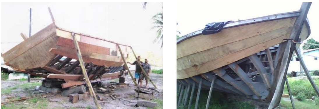
Figura 10. (A) lateral da embarcação tabuada, (B) popa da embarcação parcialmente tabuada.
