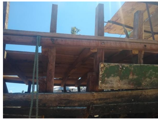
Figura 8. (A) cabeçaria a cima do cintado Mestre Zuza; (B) cabeçaria ligada à costela Barra de Sirinhaém.
