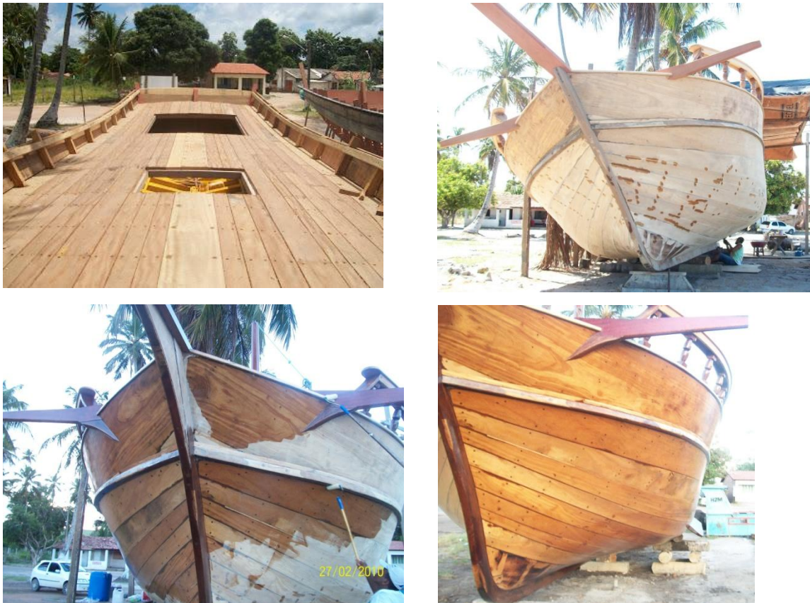
Figura 12. (A) convés totalmente tabuado e calafetado; (B) revisão de bordo a bordo; (C) aplicação de resina epóxi; (D) embarcação finalizada.
