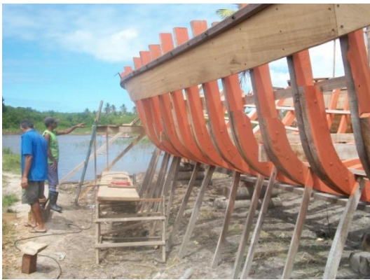
Figura 8. (A) cabeçaria a cima do cintado Mestre Zuza; (B) cabeçaria ligada à costela Barra de Sirinhaém.
