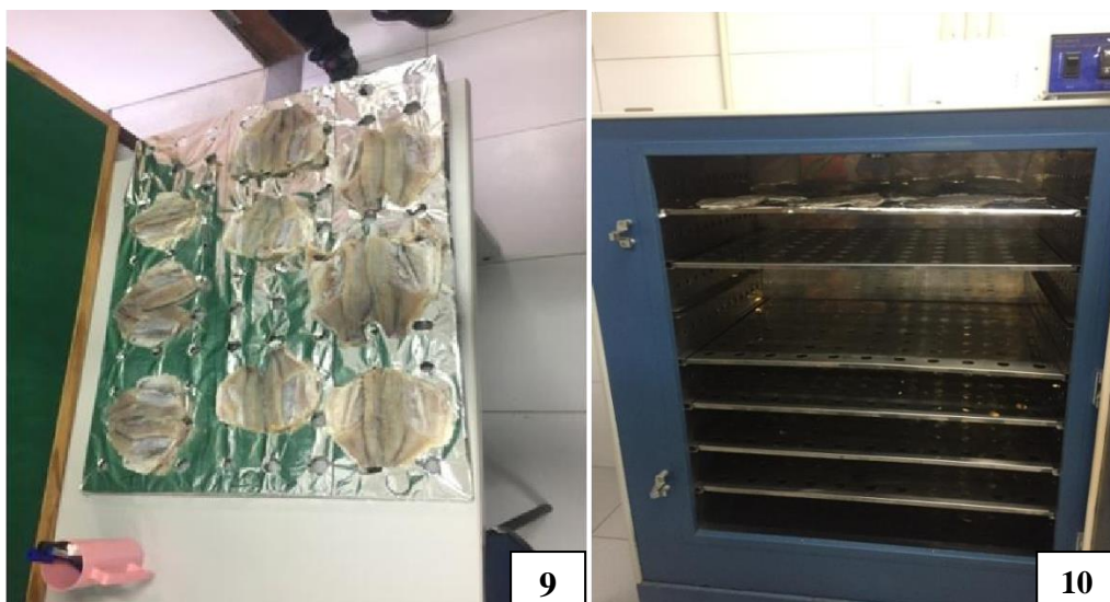
Figura 9 e 10: Processo de secagem em estufa pós-salga para verificação da umidade.
