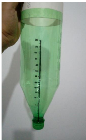
Figura 04. Pluviômetro de baixo custo.
