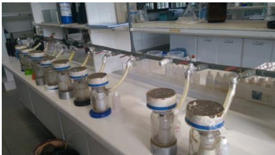
Figura 3. Sistema para obtenção do extrato da pasta de saturação para análises posteriores dos elementos solúveis.
