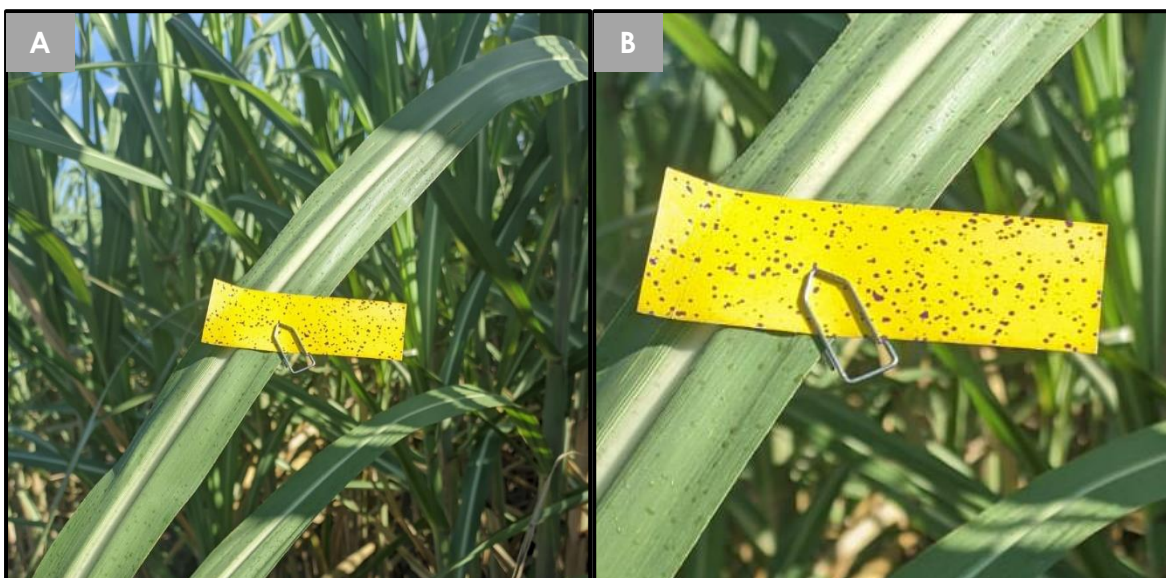
Figura 2. Papéis hidrosensíveis coletados após aplicação. Japungu Agroindustrial, Santa Rita – PB.
