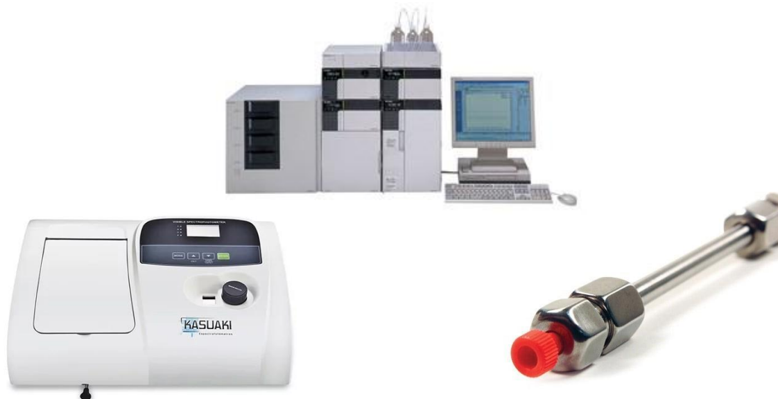
Figura 14. Espectrofotômetro, HPLC e Coluna C-18
