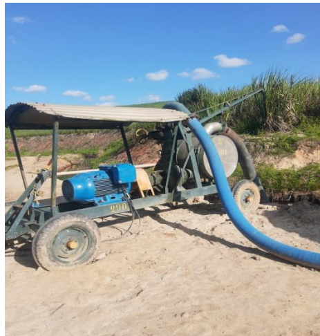
D: eletrobomba móvel.
