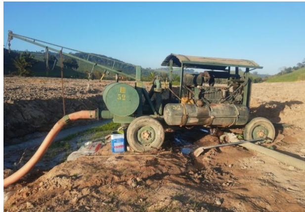
Figura 45. Motobomba a diesel.
