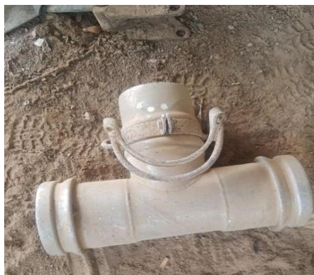
Figura 32. A. Têe de 6'' engate rápido
