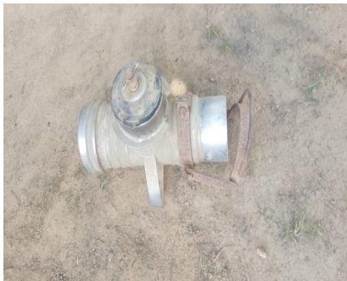
Figura 25. A. Válvula de linha 6"x 6" engate rápido.
