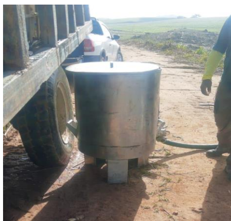
Figura 79. Tanque misturador automático.
