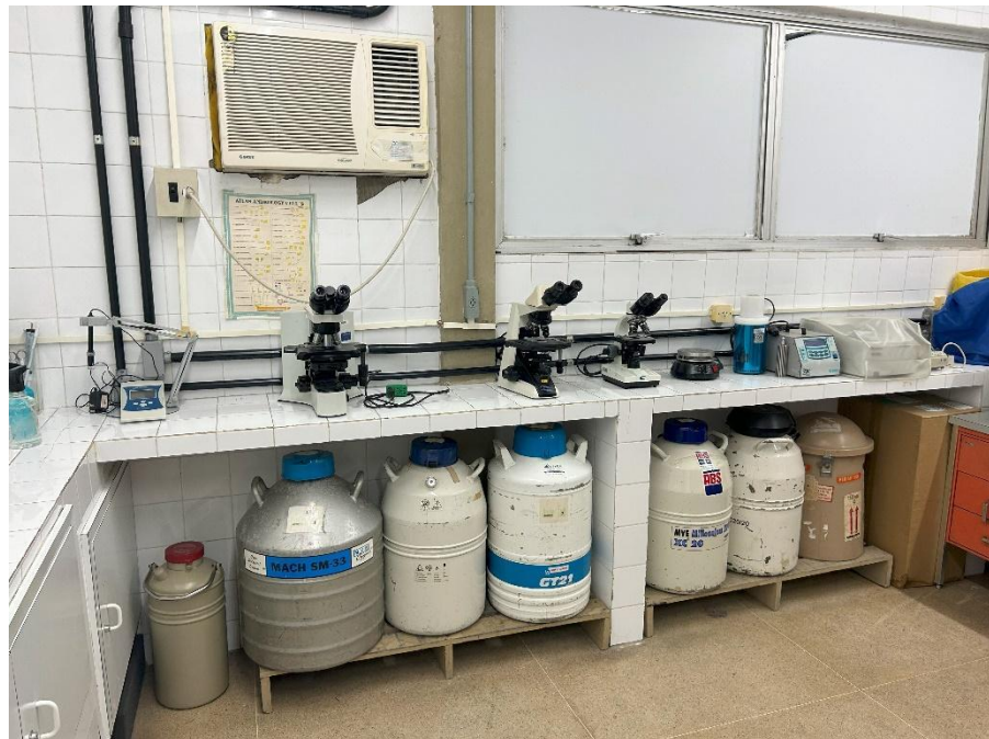
Ilustração 04. Bancada com pHmêtro, microscópios, máquina de congelamento e abaixo botijões de nitrogênio. Fonte: Couto (2023).
