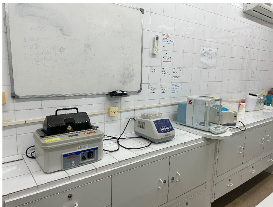
Ilustração 05. Bancada com banhos-maria, balança de precisão e osmômetro. Fonte: Couto (2023).
