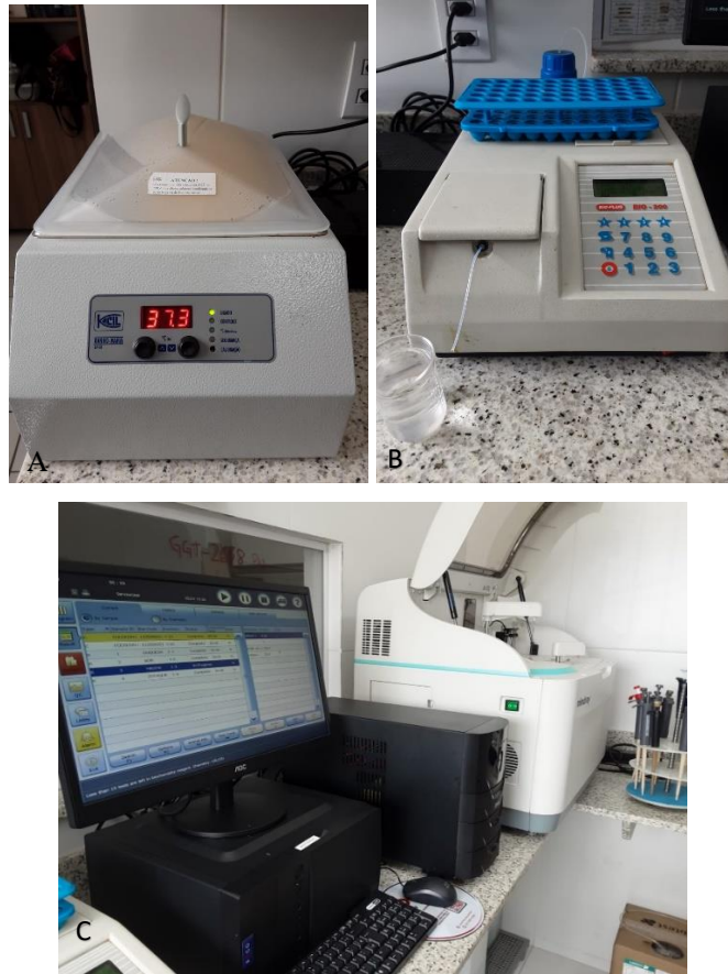
Figura 4 - Infraestrutura do laboratório de patologia clínica e geral. (A) Banho-Maria Kacil®. (B) Analisador bioquímico semiautomático Bio-plus® Bio 2000. (C) Analisador automático Mindray® BS 230-VET. Fonte: Arquivo Pessoal (2022).
