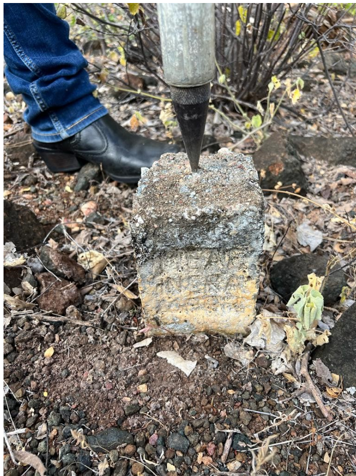
Figura 02. Marco demarcatório da Fazenda Quixaba implantado pelo INCRA no município de Belém do São Francisco/PE. (Fonte: o autor)
