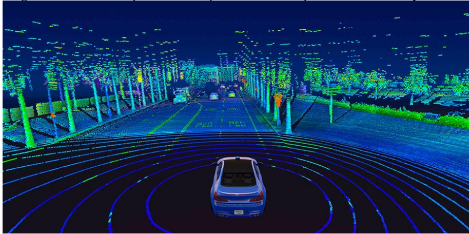
Figura 2 – Nuvem de pontos criada por um sensor Alpha Prime da Velodyne Lidar
