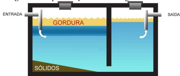
Figura 04: Representação da caixa de gordura
