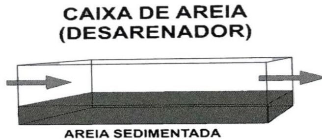
Figura 03: Representação da caixa de areia
