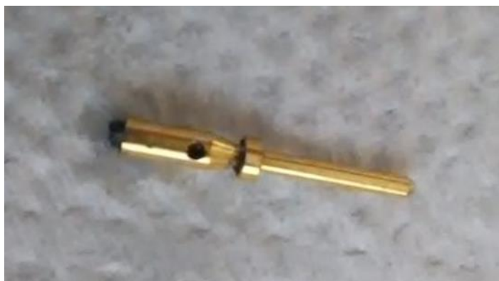
Figura 11- Eletrodo de trabalho Cramoll/MOF/Pasta de carbono.
