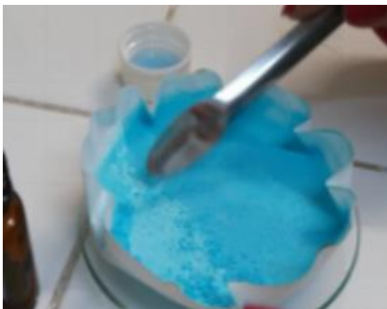
Figura 8- Resultado da MOF de [\text{Cu}_3(\text{BTC})_2(\text{H}_2\text{O})_2]_n .
