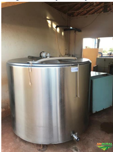
Figura 5: Tanque de expansão
