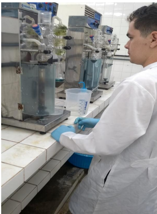
Imagem 4 – Destilando amostra no destilador de nitrogênio
