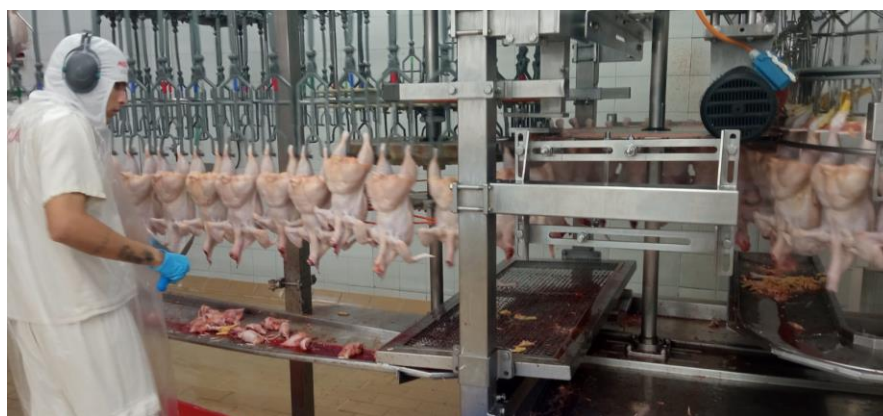
Figura 19. Degola e retirada dos pés
