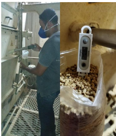
Figura 6. Coleta e aferição da temperatura da ração peletizada
