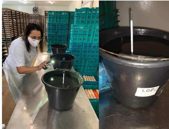
Figura 12 – Aferição da densidade com uso de densímetro.
