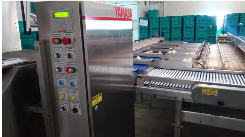
Figura 8 – Classificadora de ovos por diferença de peso.
