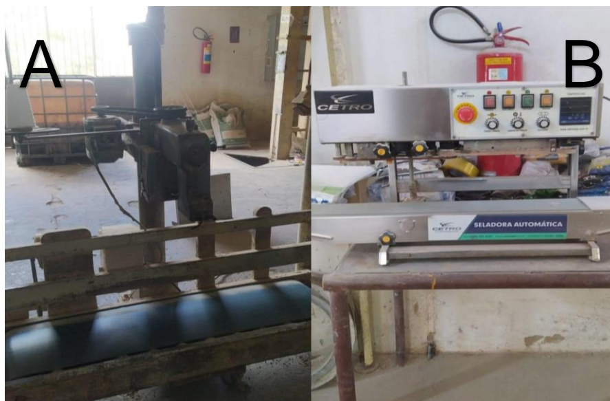
Figura 18. Seladora Matisa do tipo máquina de costura (18A) e seladora automática Cetro (18B).
