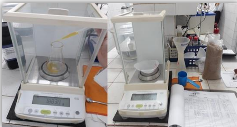
Figura 16. Pesagem de óleo vegetal para análise de acidez. (Fonte: Acervo pessoal).
