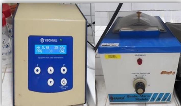
Figura 13. Determinação de pH por meio da atividade ureática. (Fonte: Acervo pessoal).
