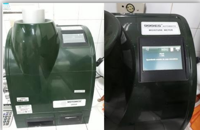
Figura 6. Detector de Umidade. (Fonte: Acervo pessoal).
