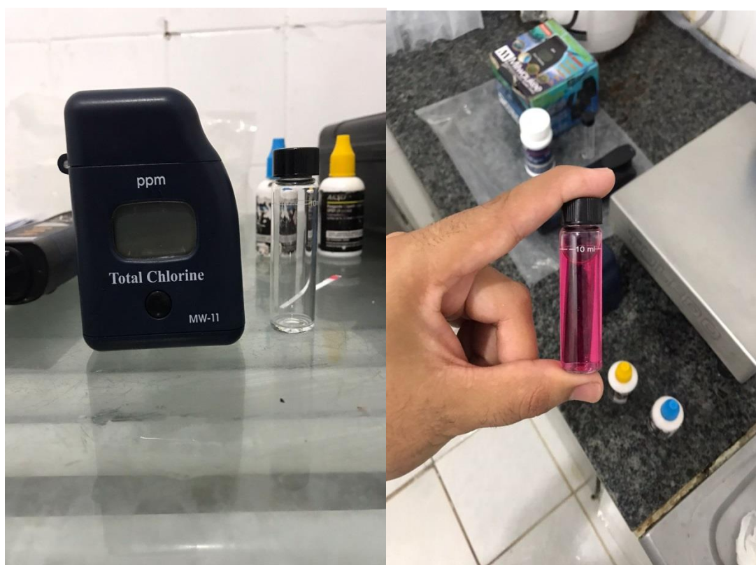
Figura 13 – (A e B): Clorímetro, medidor de ppm de cloro
