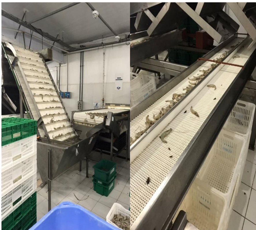
Figura 8 (A e B): Esteira de Classificação de camarão
