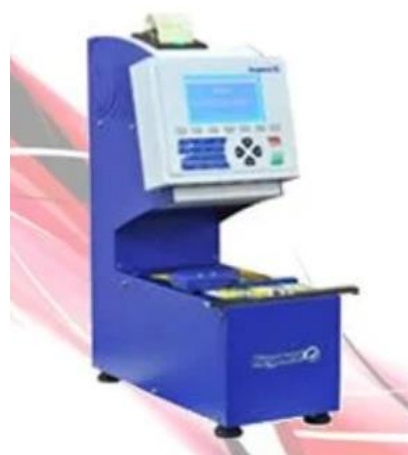
Figura 3: Medidor de Coeficiente de atrito COF21 utilizado.
