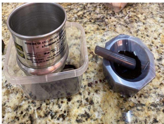
Figura 5: Almofariz de Ágata e peneira utilizada no beneficiamento e peneiramento.
