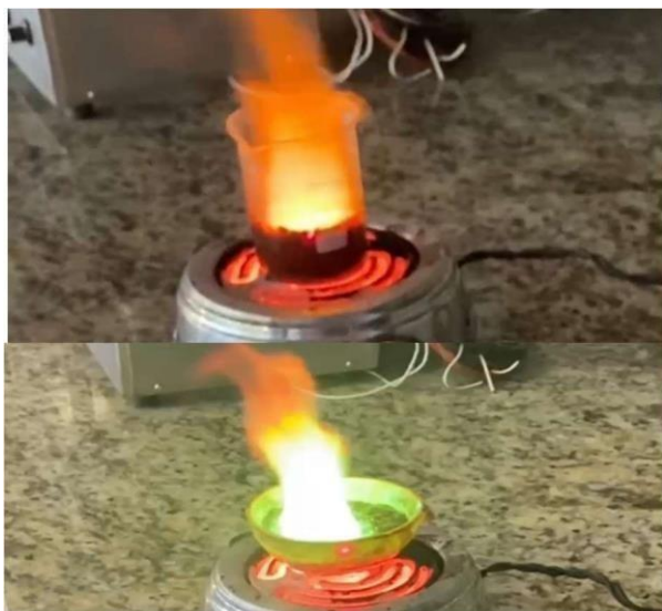
Figura 4: Reação de Combustão de \text{CoFe}_2\text{O}_4 no Becker (superior). | Reação de combustão de \text{CuFe}_2\text{O}_4 no Cadinho de sílica (inferior).
