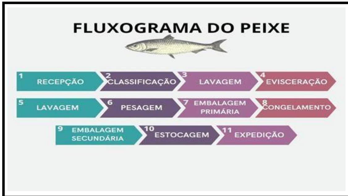
Figura 4 - Fluxograma da Produção do peixe. Fonte: (Carapitanga Indústria de pescados do Brasil LTDA, 2023).
