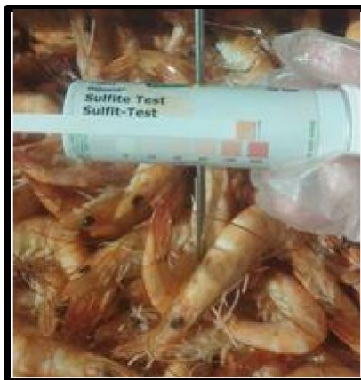
Figura 8 - Medição da quantidade de enxofre pela fita de Merck Fonte: Arquivo pessoal (2023).
