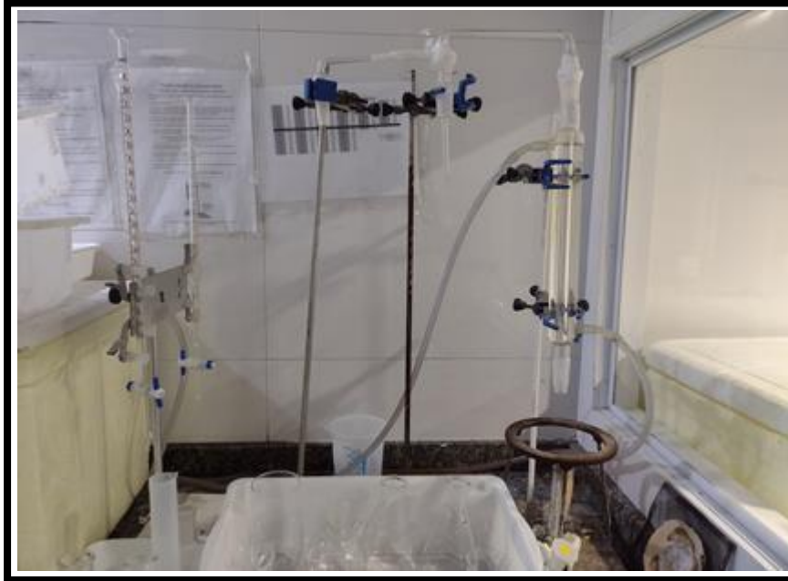
Figura 9 - Método de Monier-Williams (adaptado). Fonte: Arquivo Pessoal (2023).
