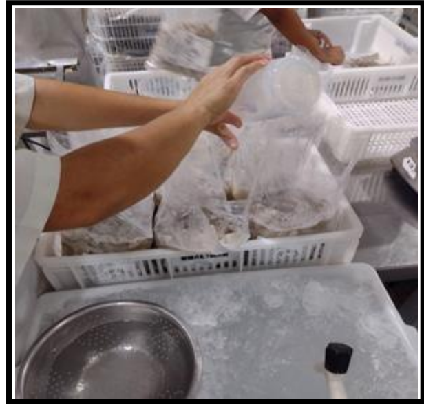
Figura 12 - Adição de água para formação de gelo no blocado. Fonte: Arquivo pessoal (2023).
