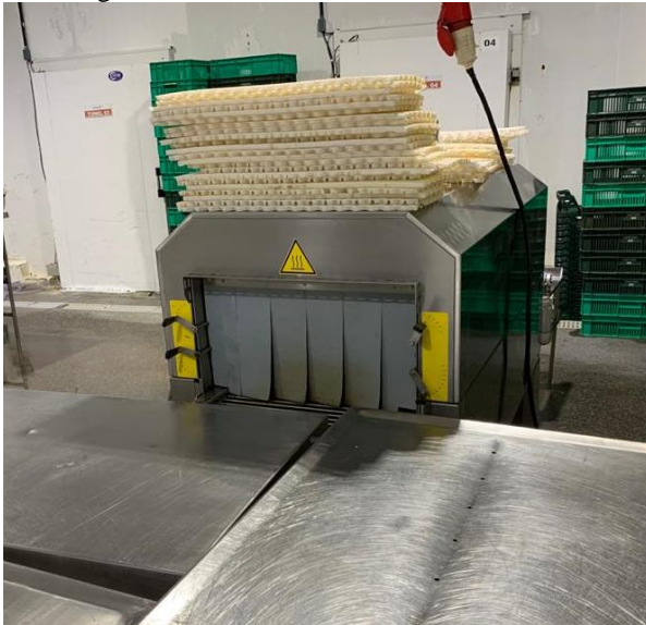
Figura 33. – Túnel para encolhimento de embalagem termoencolhível.
