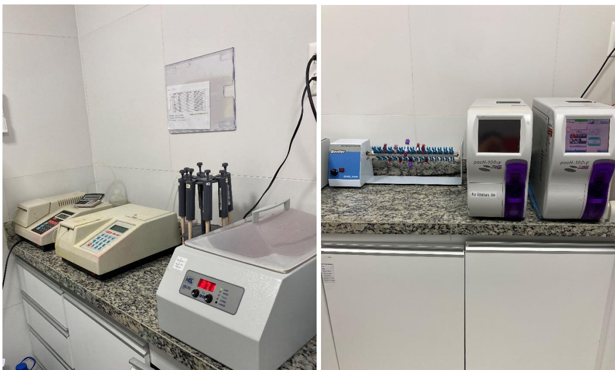
Figura 1 e 2. Sala do NEOLAB Vet equipada com as máquinas, ferramentas e insumos para as análises laboratoriais. À esquerda, as duas máquinas bioquímicas semi-automáticas Bioplus e máquina banho-maria; à direita as duas analisadoras hematológicas Sysmex Poch 100i.
